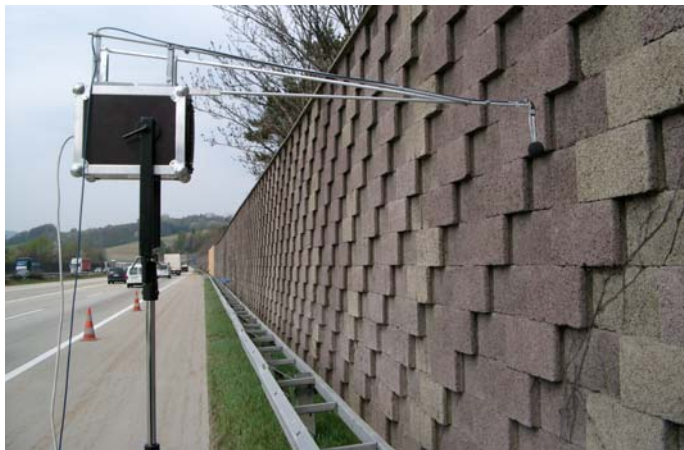
Messungen der Schallabsorption entlang der Autobahn waren trotz starkem Verkehrslärm einwandfrei möglich
