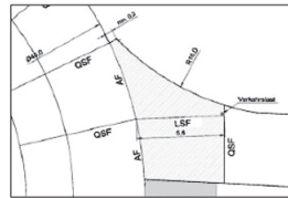
Abb. 3 (links & mitte): Verkehrslastspannungen bei einer Querkraftübertragung von 40 % (25 cm Plattendicke, 50 kN Radlast)
