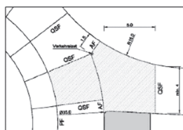
Abb. 6 (links & mitte): Verkehrslastspannungen bei einer Querkraftübertragung von 60 % (25 cm Plattendicke, 50 kN Radlast)
