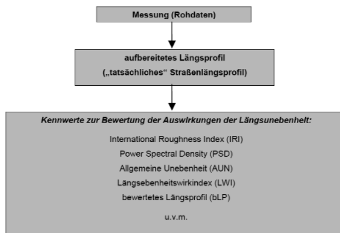
Abbildung 1-2: Generelle Übersicht der Längsebenheitsberechnung
