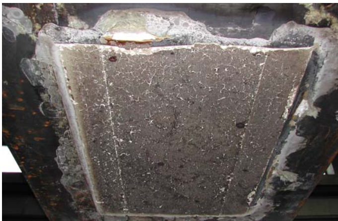
Abb. 3: Versuchskörper aus Polypropylen-Faserbeton nach gleicher Beanspruchung wie jener in Abb. 1
