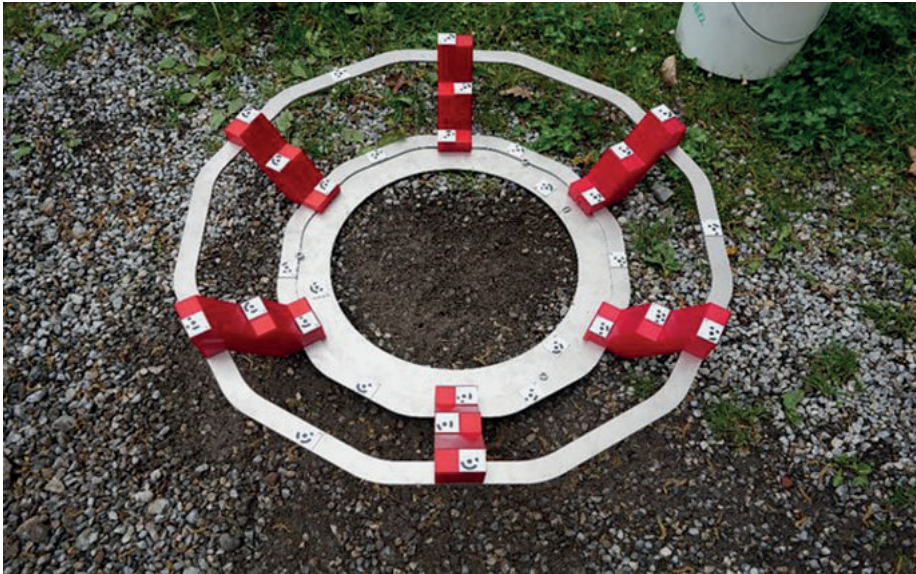
Bild 1: Passpunktkorb zur Ermittlung des richtigen Maßstabs in der photogrammetrischen Insitu-Bodendichtebestimmung
