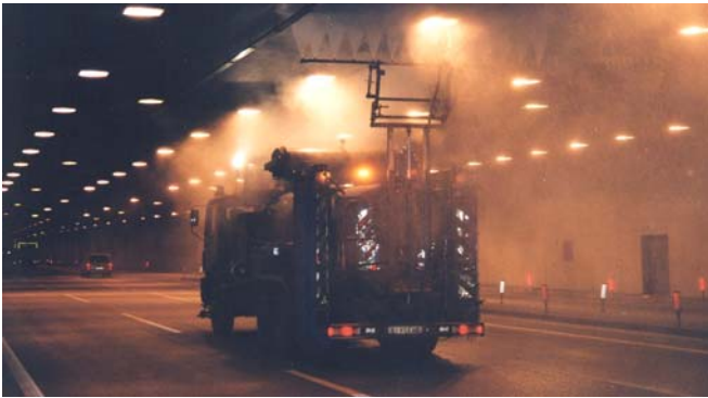
Tunnelwaschgerät im Einsatz
