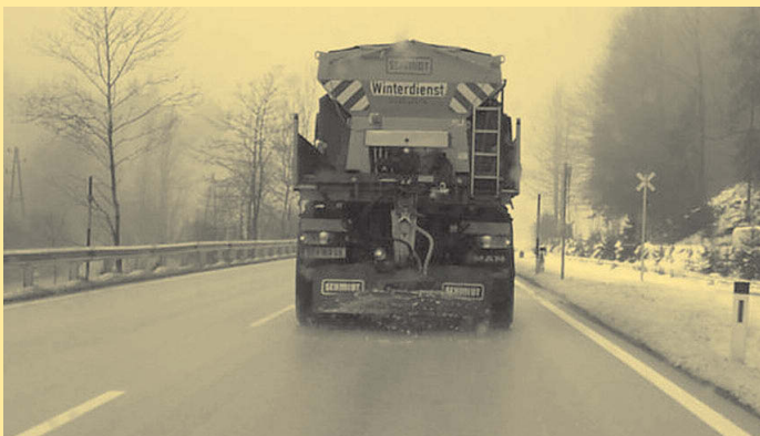
Bild 7: herkömmlicher 7\text{ m}^3 -Streuer bei einer FS50-Streuung mit 25\text{ g/m}^2 und 3,0\text{ m} Streubreite
