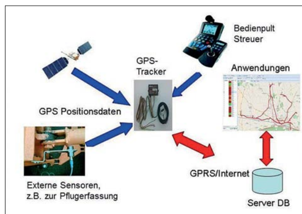
Bild 3: Systemaufbau Einsatzdatenerfassungssystem: GPS-Position, Sensordaten vom Schneepflug, Streuerdaten aus Bedienpult werden zusammengeführt und an den Datenserver übertragen; die Visualisierung erfolgt auf dem Monitor
