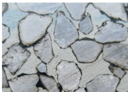
Bild 3: Schnitt durch eine vollständig vermörtelte HSD
