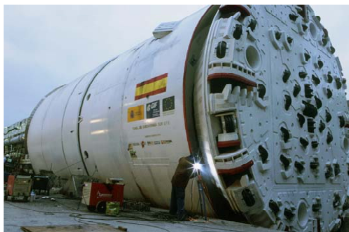
Doppelschild-Tunnelbohrmaschine, Tunes de Guadarrama (Madrid); Quelle: Firmeninformation Fa. Herrenknecht AG
