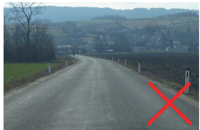
Bild 6: Optischer Knick durch eine kurze Kurve zwischen zwei Geraden
