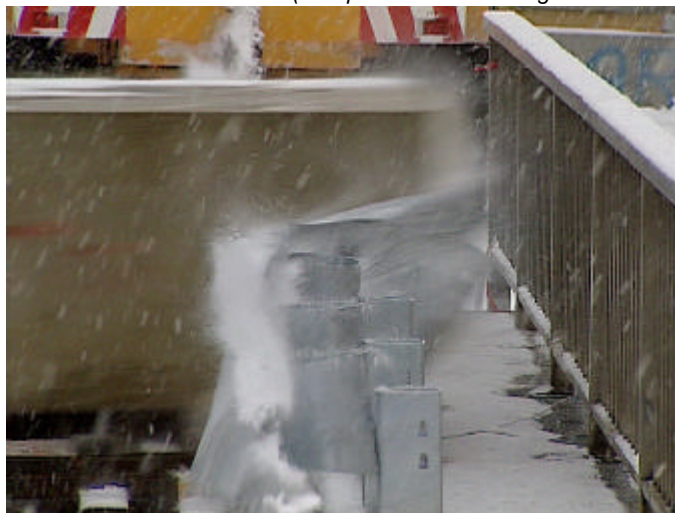
Anprall des Stahlbetonwagens auf die Stahlleitschiene
