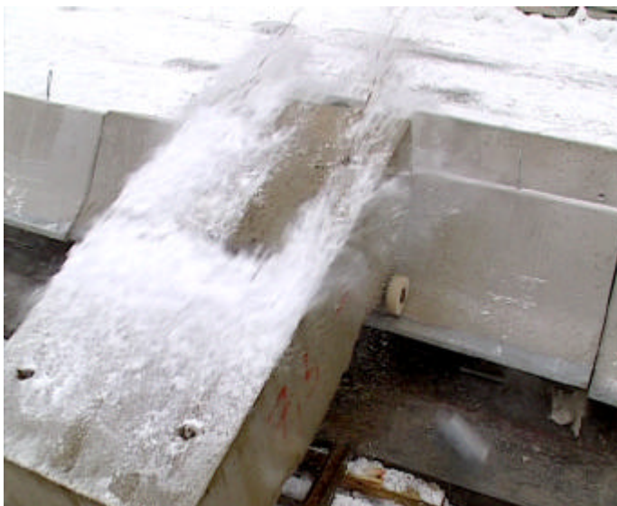
Anprall des Stahlbetonwagens auf die Betonleitwand
