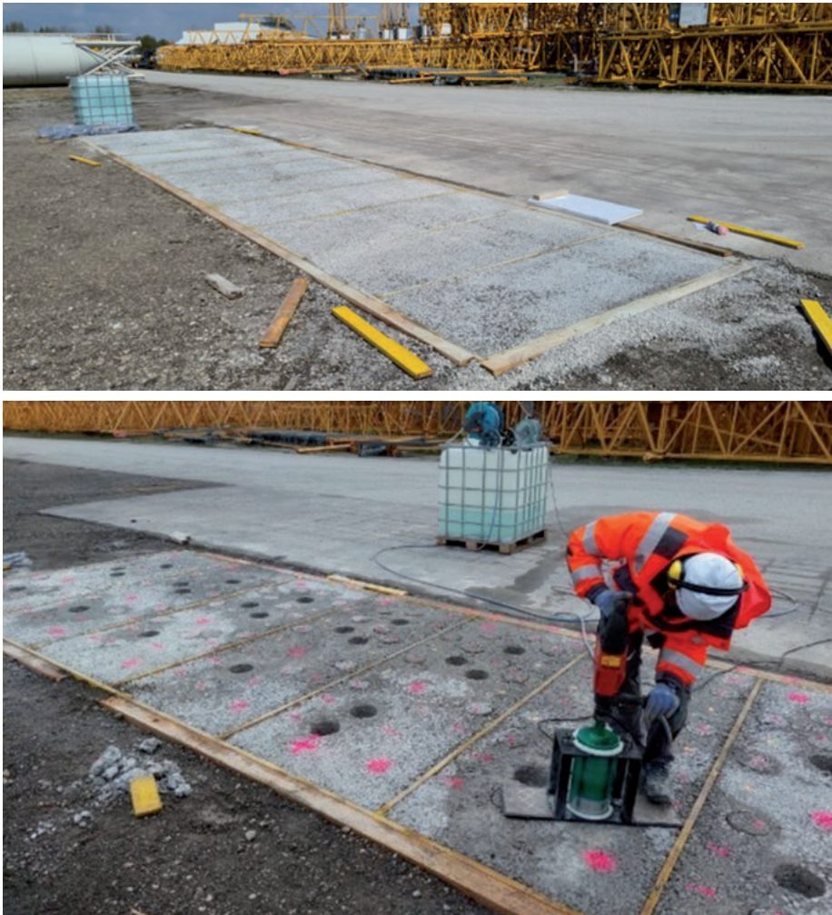
Bild 2: Beprobung eines Pflasterdrainbetons (Quelle: TPA Gesellschaft für Qualitätssicherung und Innovation GmbH)
