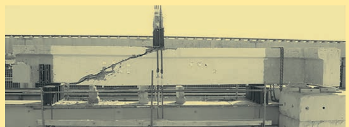
Bild 2: Träger nach dem Bruch (Hauptversuch)
