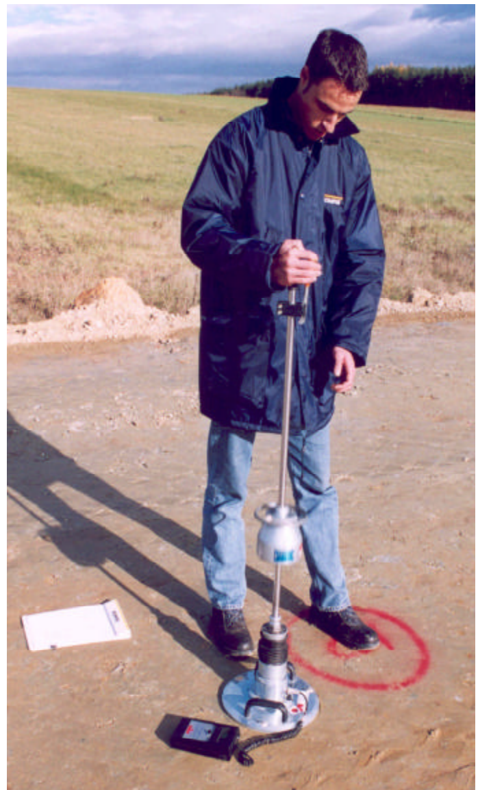
Durchführung des dynamischen Lastplattenversuches mit dem Leichten Fallgewichtesgerät
