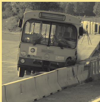
Abbildung 1 (links): Anprallprüfung TB 51 (13 t Bus, 70 km/h, 20°)
