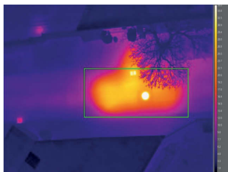
Bild 3: Inspektion von Fernwärmeleitungen
