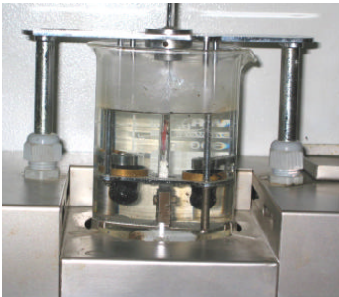
Prüfvorrichtung zur Bestimmung des Erweichungspunktes mit Ring und Kugel
