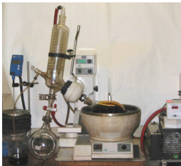
Rotationsverdampfer zur Rückgewinnung des Bitumens
