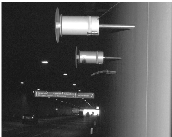
Abbildung A2: Messanordnung tunnelseitig, an der Rückwand zum Messraum. Im Vordergrund rechts 2 Digital PM10 Vorabscheider für die Bestimmung partikulärer Schadstoffe (Filterwechsler und die kontinuierliche Staub- und Rußbestimmung). Im Hintergrund rechts die gebündelten Ansaugleitungen für die Bestimmung der gasförmigen Komponenten und der PAHs (Polyzyklische Aromatische Kohlenwasserstoffe)
