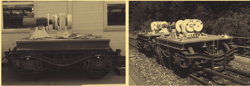
Bild 2: Entwickelter Brückenversuchswagen zur Ermittlung von Eigenfrequenz und Dämpfung von Eisenbahnbrücken mit Schotteroberbau
