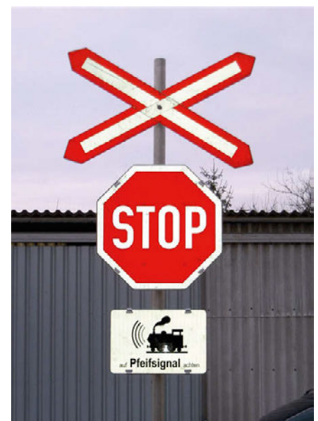
1: Eisenbahnkreuzung mit nicht technischer Sicherung mittels Andreaskreuz, Verkehrszeichen „Halt“ und Zusatztafel „auf Pfeifsignale achten“
