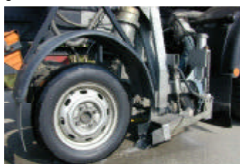
Griffigkeitsmesseinrichtung "modifizierter Stuttgarter Reibungsmesser (STURM)"
