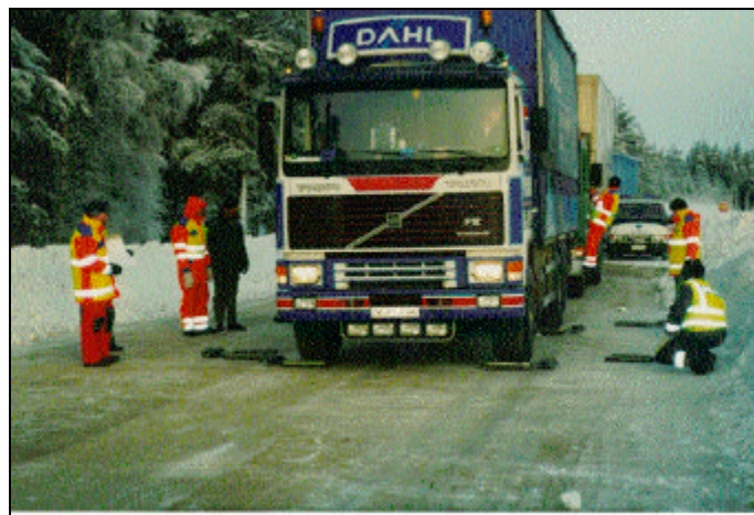
Abbildung 2: Statische Wiegung von Fahrzeugen im Zuge des CET in Nordschweden
