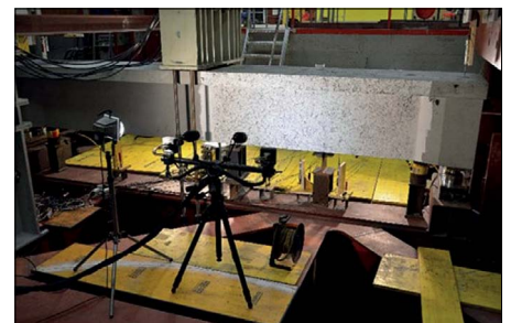
Bild 2: Versuchsaufbau mit photogrammetrischem Messsystem
