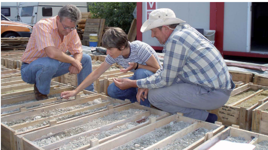
Bild 2: ExpertInnen bei der Bohrkernaufnahme
