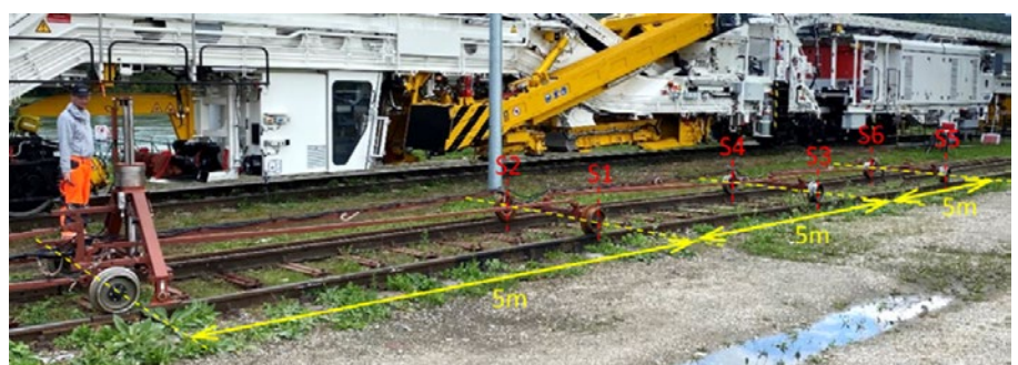
1: Messvorrichtung mit Schlagvorrichtung auf der ersten Achse (links) und drei Messachsen mit Beschleunigungsaufnehmern (S1 bis S6)
