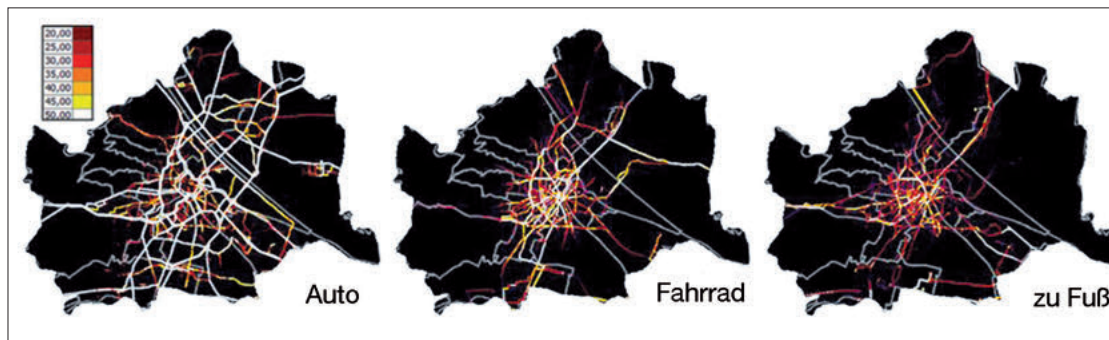
Bild 1: Darstellung der Auslastung und Routenwahl nach den Verkehrsmitteln Auto, Fahrrad und zu Fuß
