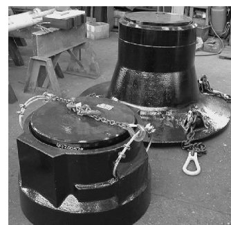
Abb. 2: Verdichtungsplatte (Hintergrund) und Schlaghaube (Vordergrund)
