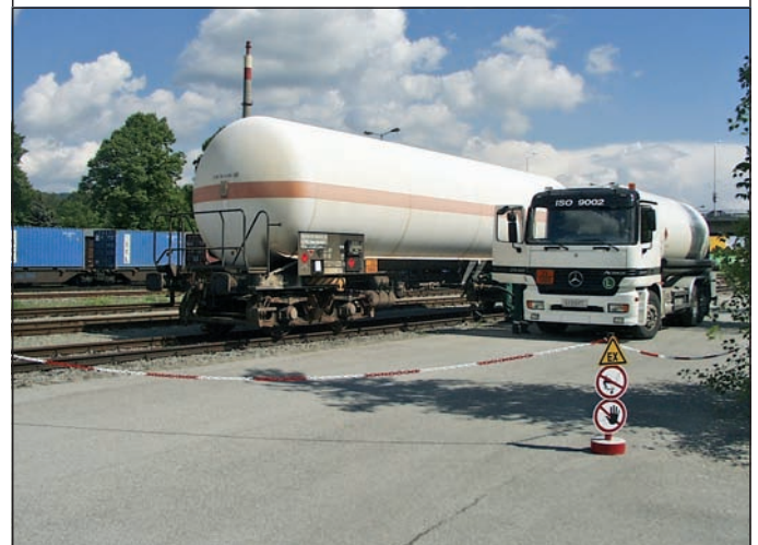
Absicherung und Kennzeichnung der Schutzzone beim Umfüllen von Flüssiggas
