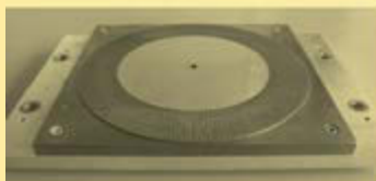
Abb. 3: Riffelplatte aus gehärtetem Stahl (links), Darstellung der Oberflächenrauheit (rechts)
