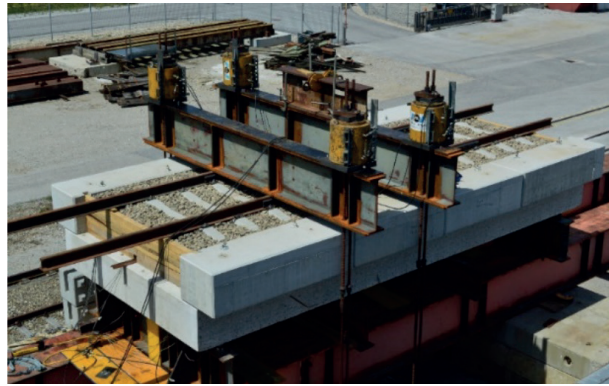
Bild 1: Versuchskörper einer realitätsnahen Plattenbrücke mit komplettem Gleisoberbau (Foto: © Tobias Huber)
