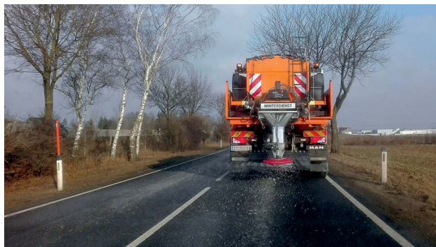
Bild 3: Feuchtsalzstreuung mit Natriumchlorid und erhöhten Soleanteilen ist Stand der Technik
