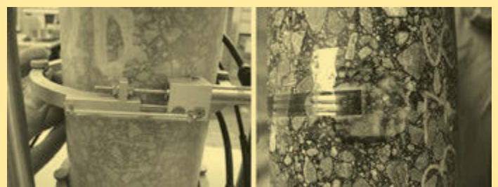
Abb. 6: Radialmessbügel über Latexmembran (li) und Dehnungsmessstreifen direkt auf Asphaltprobekörper appliziert (re)
