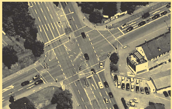
Bild 7: Verkehrslichtsignalanlage mit Verkehrsfurt
