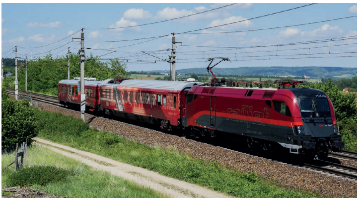
Bild 7: Zusammengekoppelte Messwägen der ÖBB – EM 160 (hinten) und EM 250 (vorne). [2]
