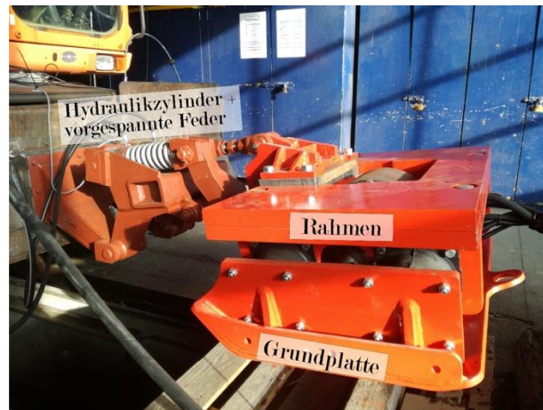
Abbildung 1: Befestigung des Plattenverdichters am Baggerschild
