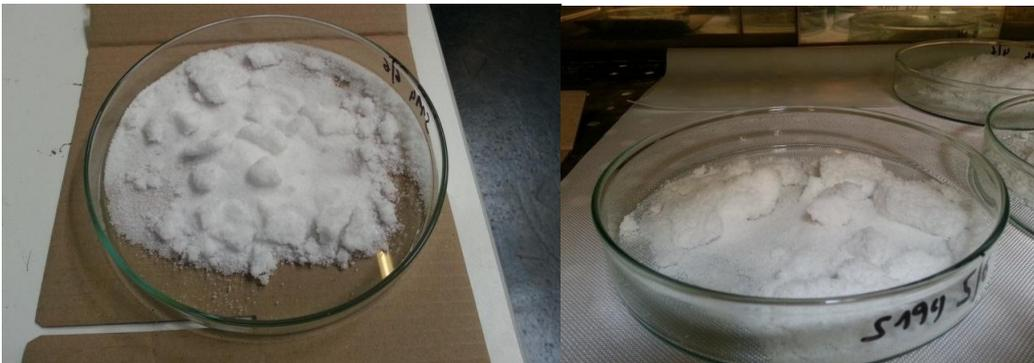
**Abbildung 27 Verklumpung der Probe nach Ofentrocknung**
